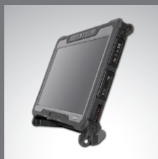
A140 的多功能坚固把手 可作为支撑架使用
